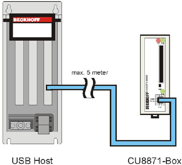
Der CFast-Karten-Adapter wird über ein Standard-USB-Kabel an den HOST-PC angeschlossen. Das Kabel darf eine maximale Länge von 3 Metern nicht überschreiten. Für den störungsfreien Betrieb sollte ein USB 3.0-taugliches Kabel verwendet werden.
