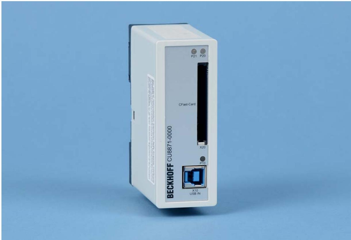
Der CU8871-0000 bietet einen CFast-Adapter mit USB-Anschluss in einem kompakten Gehäuse zur Hutschienenmontage. CFast-Flashkarten werden im industriellen Umfeld als Datenspeicher für Prozess- und Steuerdaten eingesetzt. Die CFast-Karten sind im CU8871-0000 hotplugfähig und können so als Wechseldatenträger zum Datenaustausch mit anderen PCs während des Betriebs gesteckt und gezogen werden.
