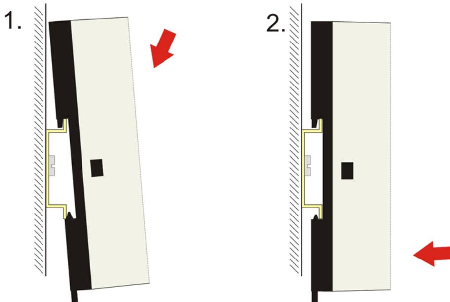
Um den CU8871-0000 von der Hutschiene zu entfernen:
