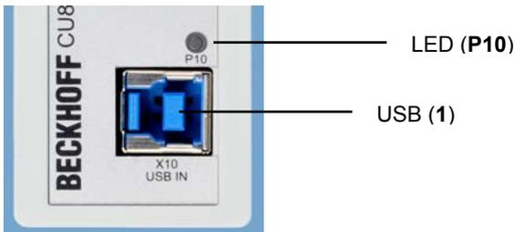
Der USB-CFast-Karten-Adapter benötigt keine zusätzliche Stromversorgung. Der benötigte Strom (5V DC) wird über den USB-Anschluss (1) bezogen. Wenn der Adapter mit Strom versorgt wird, leuchtet die LED (P10) grün auf.
