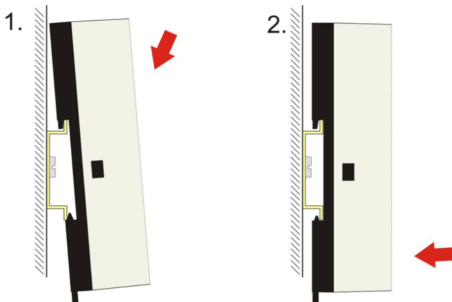
Um den CU8800-0010 von der Hutschiene zu entfernen:
