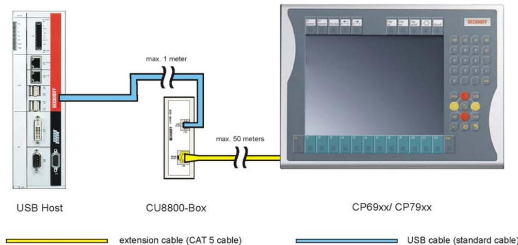
Diese Konfiguration zeigt den Anschluss eines CP69xx/ CP79xx Control-Panels an die CU8800 Extension-Box. Die maximale Länge der Erweiterung beträgt 51 Meter: 1 Meter Kabel vom Host-Computer zur CU8800 Extension-Box; bis zu 50 Meter Extension Kabel zum Control-Panel.
