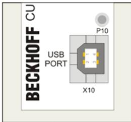
Der USB-Extender-Tx benötigt keine zusätzliche Stromversorgung. Der benötigte Strom (5 V DC) wird über den USB-Anschluss bezogen. Wenn die Box mit Strom versorgt wird, leuchtet die LED **P10** grün.
