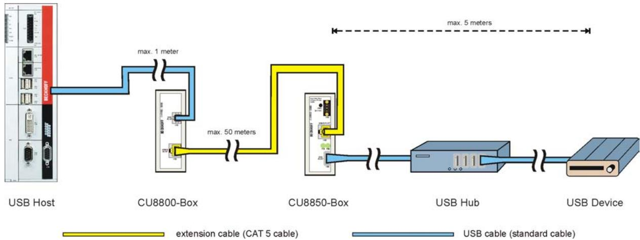
Der USB-Hub ist nach der Erweiterung angeschlossen. Die maximale Verlängerung beträgt 56 Meter: 1 Meter Kabel vom Host-Computer zur Extension-Box CU8800; bis zu 50 Meter Extension Kabel; 5 Meter von der Extension-Box über den USB-Hub bis zum USB-Gerät.
