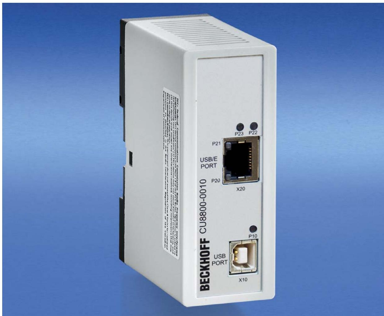
Der Beckhoff CU8800-0010 USB-Extender-Tx erlaubt es, die Beschränkungen der Kabelänge bei USB-Kabeln zu umgehen. Ein USB-Kabel darf gemäß Spezifikation eine maximale Länge von 5 Metern haben. Mit Hilfe der Erweiterungsbox kann diese Entfernung auf bis zu 50 Meter erweitert werden. Die Einheit sendet eingehende USB-Signale zu den Empfängern CU8850 und CU8860. Die wichtigsten Eigenschaften sind:
