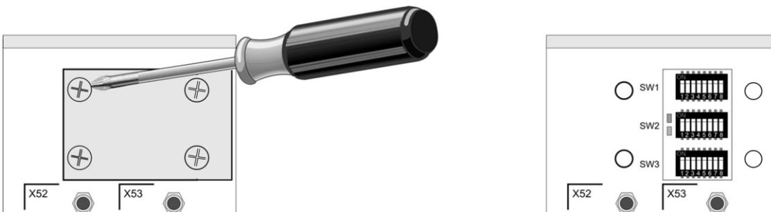
Hinter der Abdeckung befinden sich drei DIP-Schalterblöcke und zwei Status-LEDs. Im Folgenden sind die detaillierten Funktionen beschrieben.
