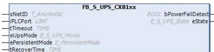
Beim CX81xx wird der Funktionsbaustein FB\_S\_UPS\_CX81xx k verwendet, um die Sekunden-USV aus der SPS anzusteuern. Verwenden Sie möglichst die Standardwerte des FB\_S\_UPS\_CX81xx und rufen Sie den Funktionsbaustein zyklisch in der SPS auf.
