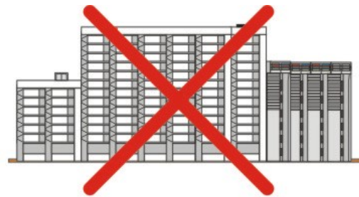
ungültige Installationslage invalid position
