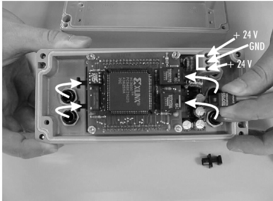
Der Stecker, aus dem bei eingeschaltetem Beckhoff-Lightbus rotes Licht austritt, muß mit der Buchse „IN“ verbunden werden. Die Beschriftung „IN“ und „OUT“ finden Sie auf der Oberseite des Gehäuses. Beachten Sie bei der Steckermontage die Beckhoff Lichtleiter Installationsanweisung.
