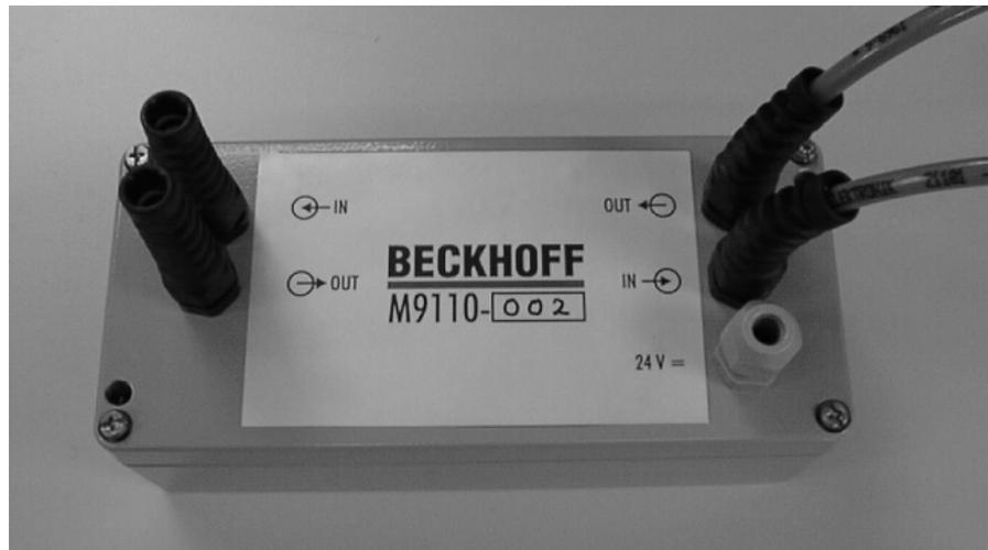
Der Bidirektionale Beckhoff Lightbus Verstärker M9110 wird benötigt, wenn Kunststoff-Lichtleiterkabel von mehr als 45 m Länge verlegt werden müssen, ohne daß Glasfaserkabel verwendet werden sollen.
