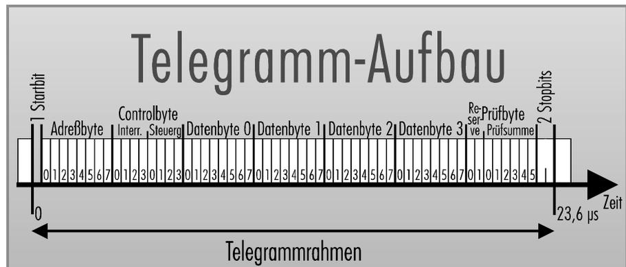
Stimmt der Inhalt des Adressbytes eines Telegramms mit der Adresse des Moduls M4110 überein, werden die im Telegramm enthaltenen Informationen wie Sollwert oder Freigabesignale aus den Datenbytes 0 bis 2 entnommen und die Zustandsmeldungen in das dritte Datenbyte geschrieben.
