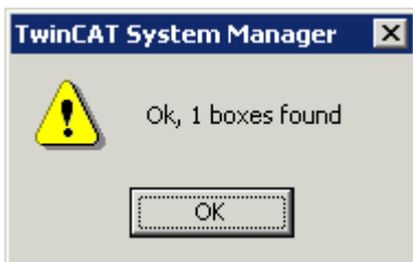
Abb. 17: Der Test gibt die Anzahl der im Ring gefundenen E/A-Module (Boxen) an
