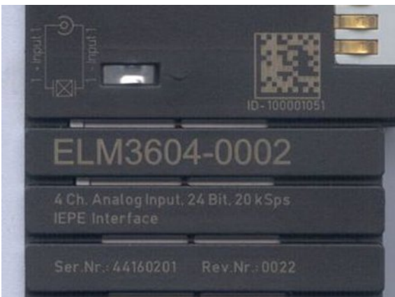
Abb. 18: ELM3604-0002 Klemme mit eindeutiger ID-Nummer (QR Code) 100001051 und Seriennummer/ Chargennummer 44160201
