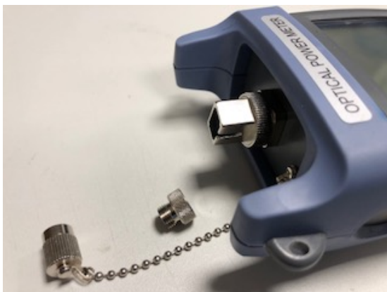
OPM mit aufgeschraubtem SC Adapter
