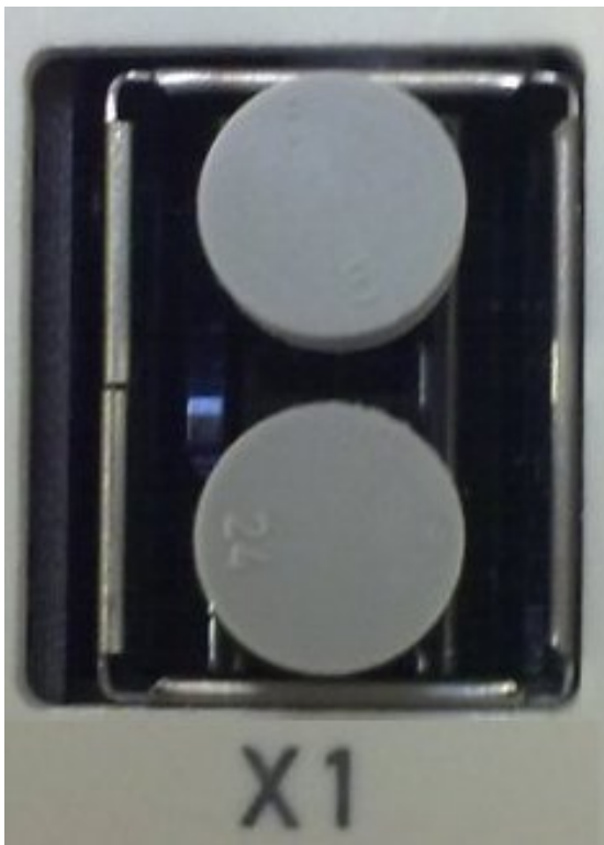
Abb. 31: Blindstopfen in nicht verwendeten Anschlussbuchsen
