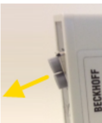
Abb. 23: Schräger Einbau der LWL-Buchse
