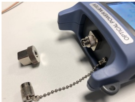
OPM mit aufgeschraubtem FC Adapter
