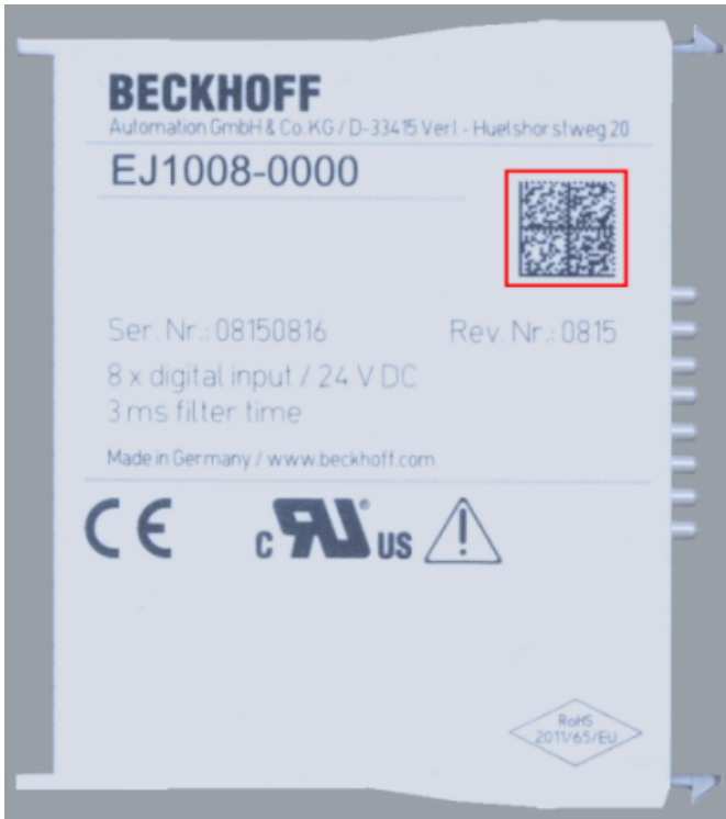
Abb. 3: BIC als Data Matrix Code (DMC, Code-Schema ECC200)
