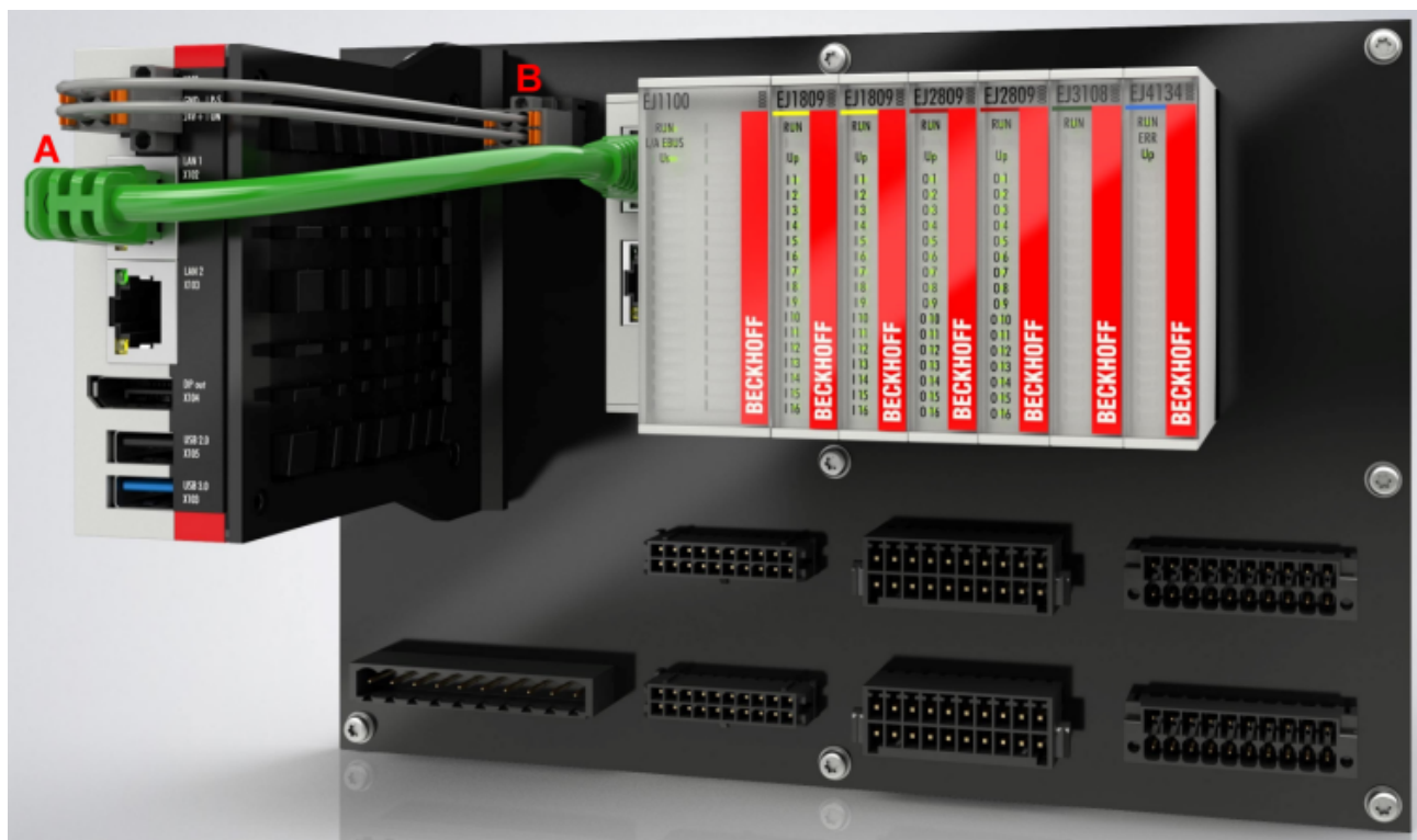
Abb. 24: Beispiel für die Anbindung des IPC C6015 an ein EJ-System
