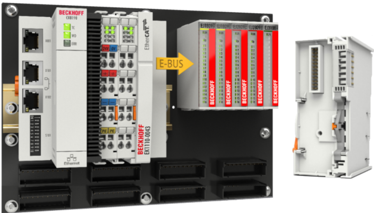
Abb. 17: Leiterkarte mit Embedded PC, EK1110-0043 und EJxxxx, Rückansicht EK1110-0043
