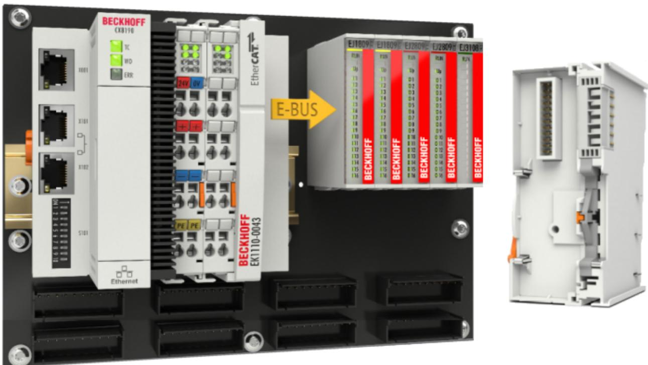
Abb. 35: Beispiel Leiterkarte mit Embedded PC, EK1110-0043 und EJxxxx, Rückansicht EK1110-0043
