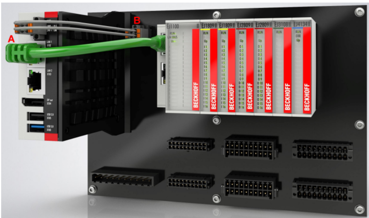
Abb. 30: Beispiel für die Anbindung des IPC C6015 an ein EJ-System
