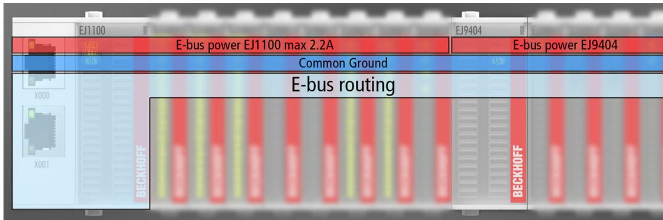
Abb. 11: Verwendung des Netzteil-Steckmoduls EJ9404 zur E-Bus-Auffrischung
