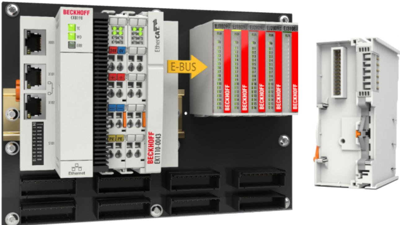
Abb. 26: Beispiel Leiterkarte mit Embedded PC, EK1110-0043 und EJxxxx, Rückansicht EK1110-0043
