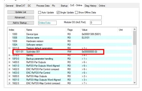
Fig. 8: Selecting the Restore default parameters PDO
