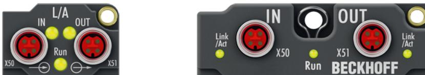
Abb. 2: Steckverbinder für EtherCAT P
