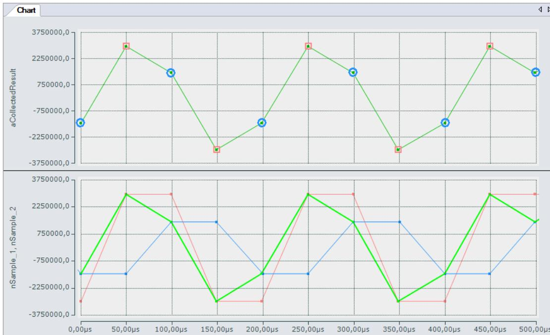
Abb. 31: Oversampling 20 KSps mit 2 x EL3751 zeigt abwechselnd den Eingangswert 1 und Eingangswert 2 für je einen Ergebniswert
