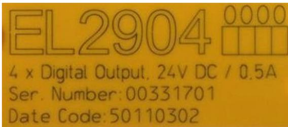
Abb. 20: EL2904 IP20 Safety Klemme mit Chargennummer/ DateCode 50110302 und eindeutiger Seriennummer 00331701
