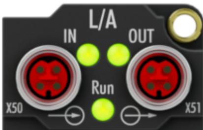
Abb. 6: ECAT-P-Steckverbinder an EtherCAT-P-Box
