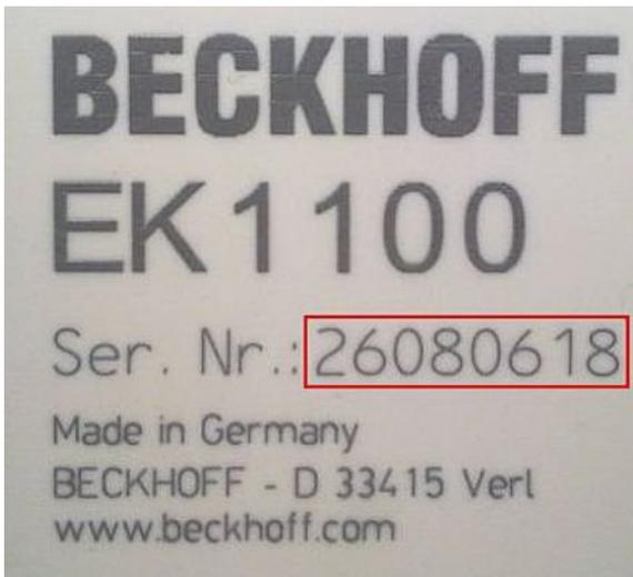
Abb. 15: EK1100 EtherCAT Koppler, Standard IP20-IO-Gerät mit Seriennummer/ Chargennummer
