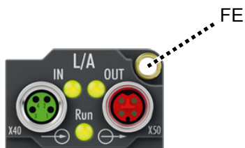
Abb. 4: Anschluss für die Funktionserdung (FE)
