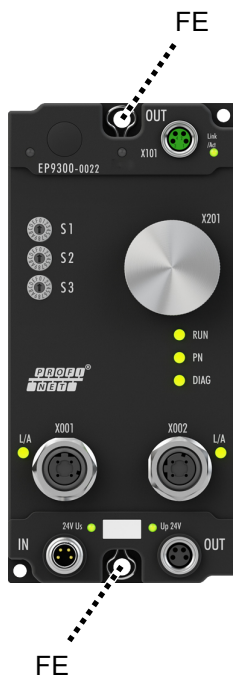
Abb. 4: Funktionserdung über die Befestigungslöcher
