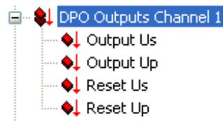
Die EP9224 verfügt über 4 x 16 Bit Ausgangsdaten der vier Ausgangskanäle **DPO Outputs Channel n**.
