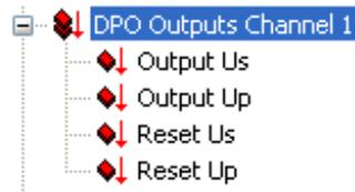
Die EP9214 verfügt über 4 x 16 Bit Ausgangsdaten der vier Ausgangskanäle **DPO Outputs Channel n**.
