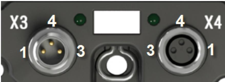
Abb. 11: EP9214 - Monitoring- und Reset-Kontakte
