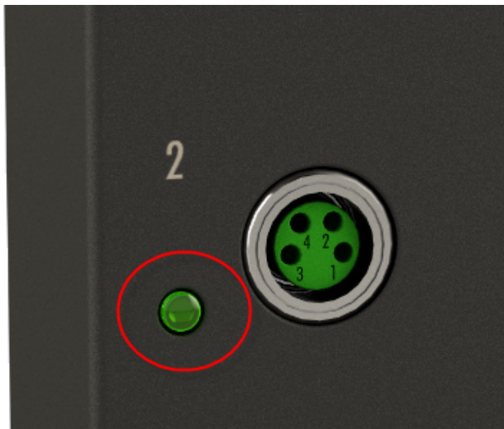
Abb. 14: LED-Anzeigen pro Kanal
