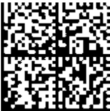
Fig. 28: Example DMC 1P 072222 S BTNk4p562d7 1K EL1809 Q 1 51S 678294
