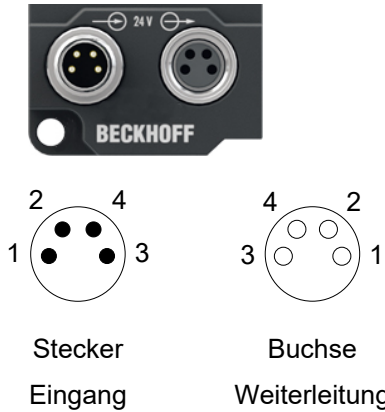
Abb. 3: M8-Steckverbinder
