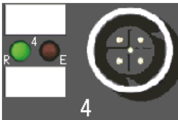
Abb. 7: Status- und Diagnose-LED am M12-Steckverbinder
