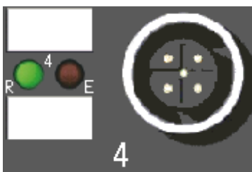
Abb. 6: Status- und Diagnose-LED am M12-Steckverbinder
