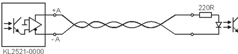
Abb. 14: KL2521-0000 - direkter Anschluss an einem Optokoppler
