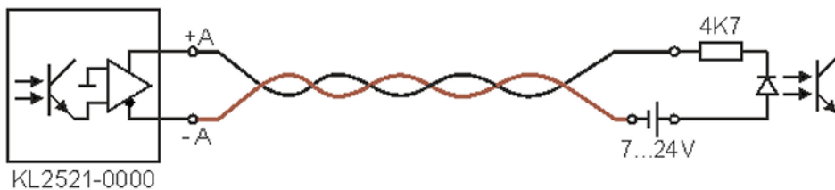
Abb. 15: KL2521-0000 bis Hardware 03 - Beschaltung mit externer Stromquelle
