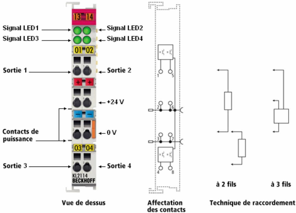
**Bornes de sortie digitales à 4 canaux, 24 V<sub>CC</sub>**
