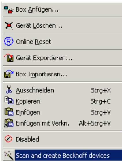
Abb. 19: Einlesen der angeschlossenen Buskoppler und Busklemmen
