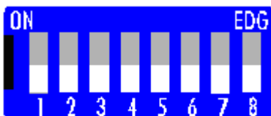
Abb. 25: DIP-Schalter auf BK5110, BK5120 und LC5100 - Einstellen der Baud-Rate
