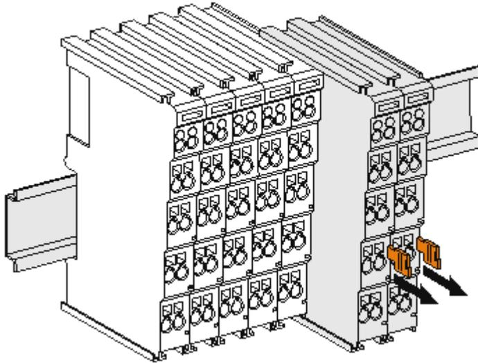
Abb. 16: Demontage von Tragschiene
