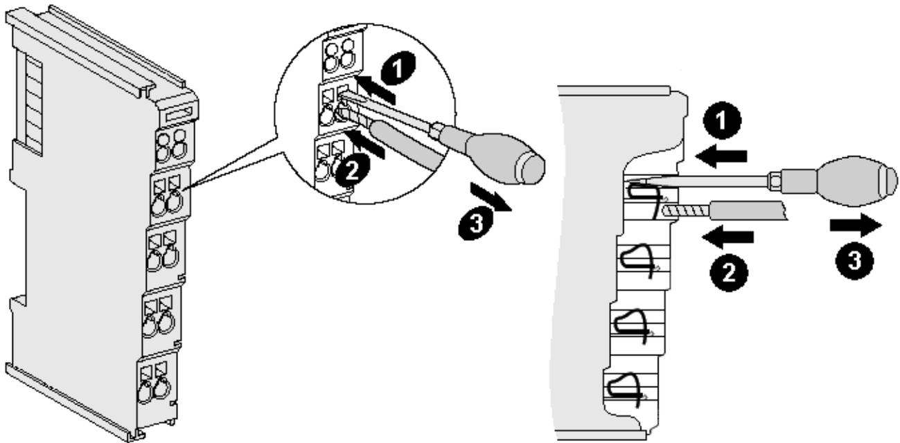
Abb. 8: Anschluss einer Leitung an einer Klemmstelle
