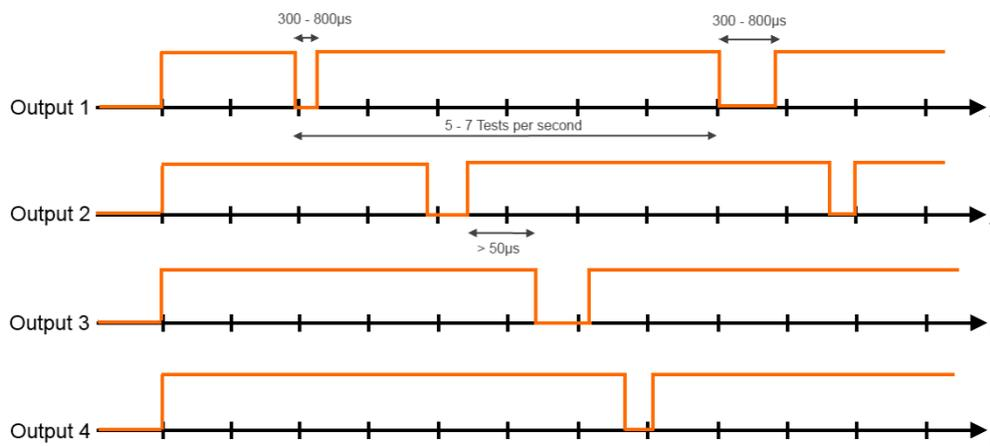
Abb. 12: Typischer Verlauf von Testpulsen der Ausgänge
