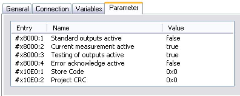
Abb. 23: Parameter der TwinSAFE-Verbindung einstellen
