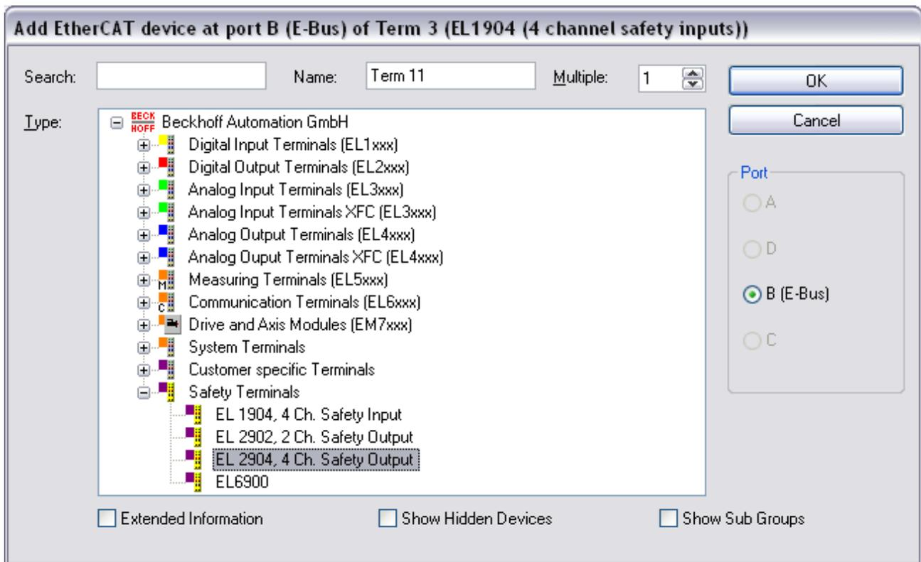
Abb. 19: Einfügen einer EL2904
