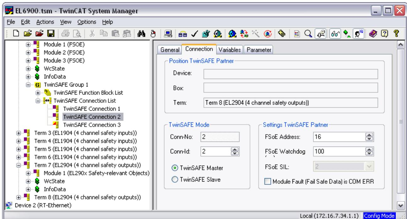
Abb. 22: Connection der TwinSAFE-Verbindung einstellen
