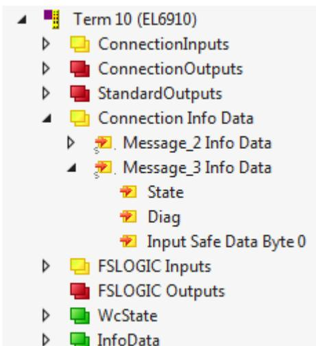
Abb. 87: Info-Daten der Connection in der I/O-Baumstruktur als ByteArray
