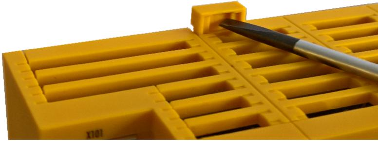
Abb. 20: Hutschienerarretierung geöffnet
