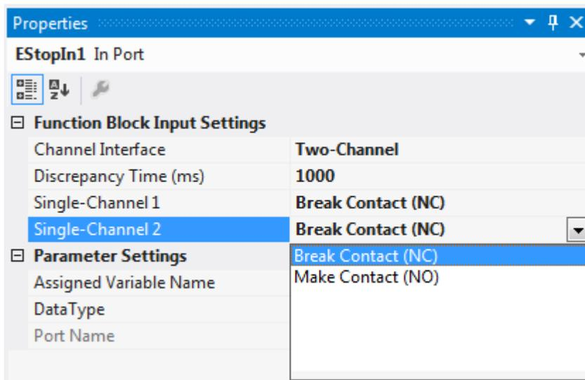
Abb. 71: Einstellung, ob Schließer- (Make Contact, NO) oder Öffner-Kontakt (Break Contact, NC)
