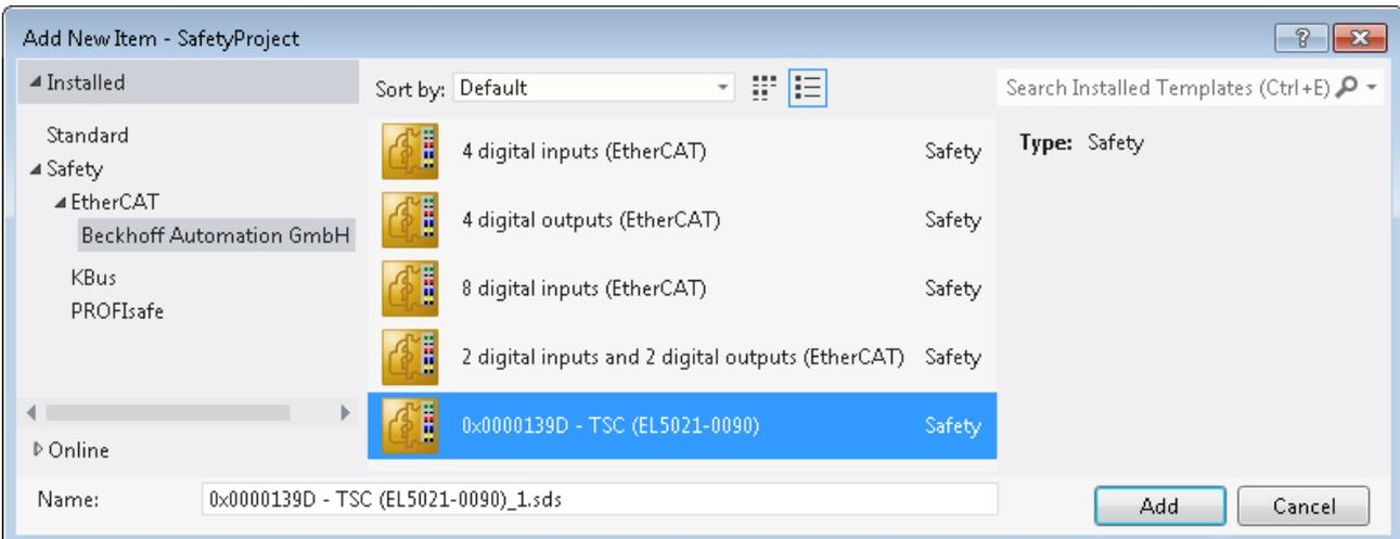
Abb. 116: Hinzufügen einer TwinSAFE-SC-Verbindung
