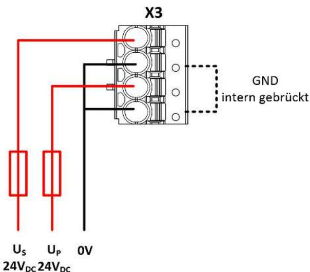
Abb. 11: Spannungsversorgung X3
