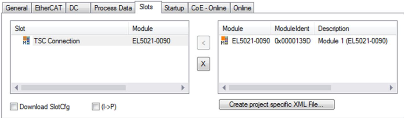
Abb. 114: Hinzufügen der TwinSAFE-SC-Prozessdaten unterhalb der Komponente z.B. EL5021-0090
