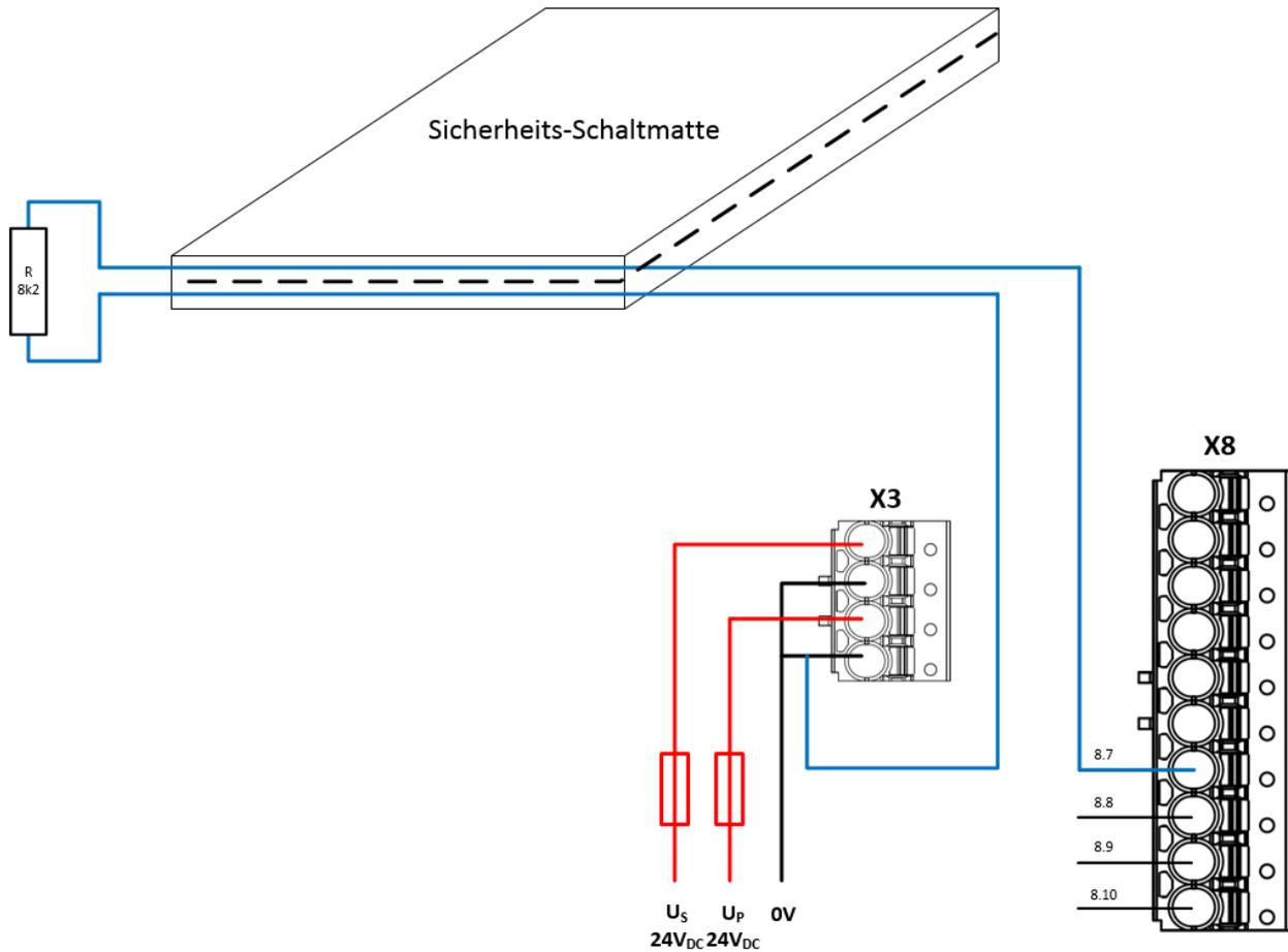
Abb. 15: Verdrahtung Sicherheitsschaltmatte
