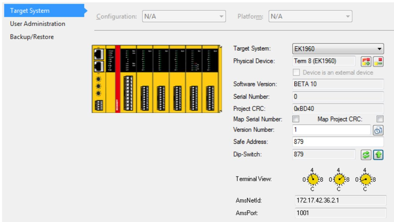
Abb. 28: Verknüpfen von Target System und TwinSAFE-Compact-Controller
