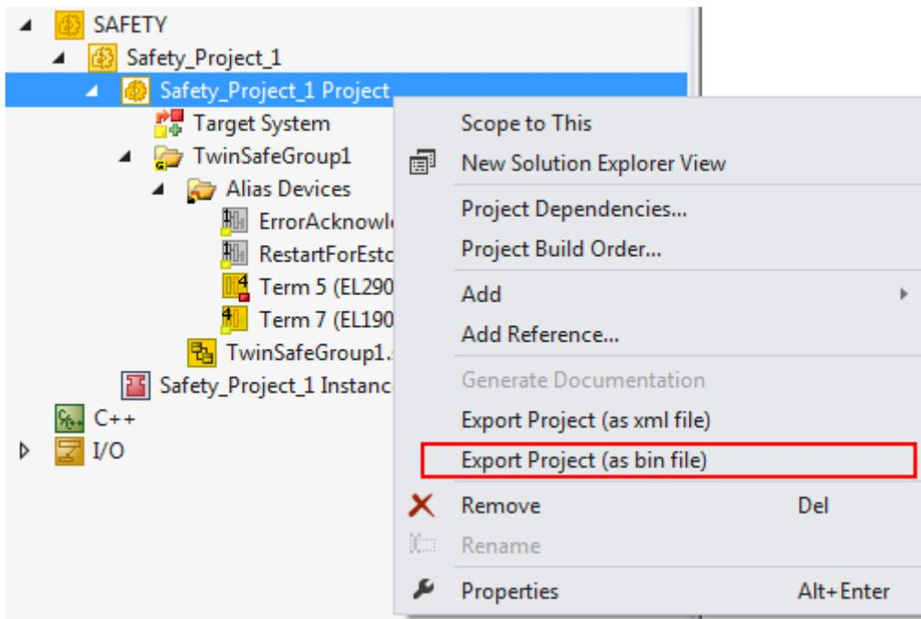
Abb. 109: Speichern des Safety-Projektes in einem binären Format (z.B. für den TwinSAFE-Loader)
