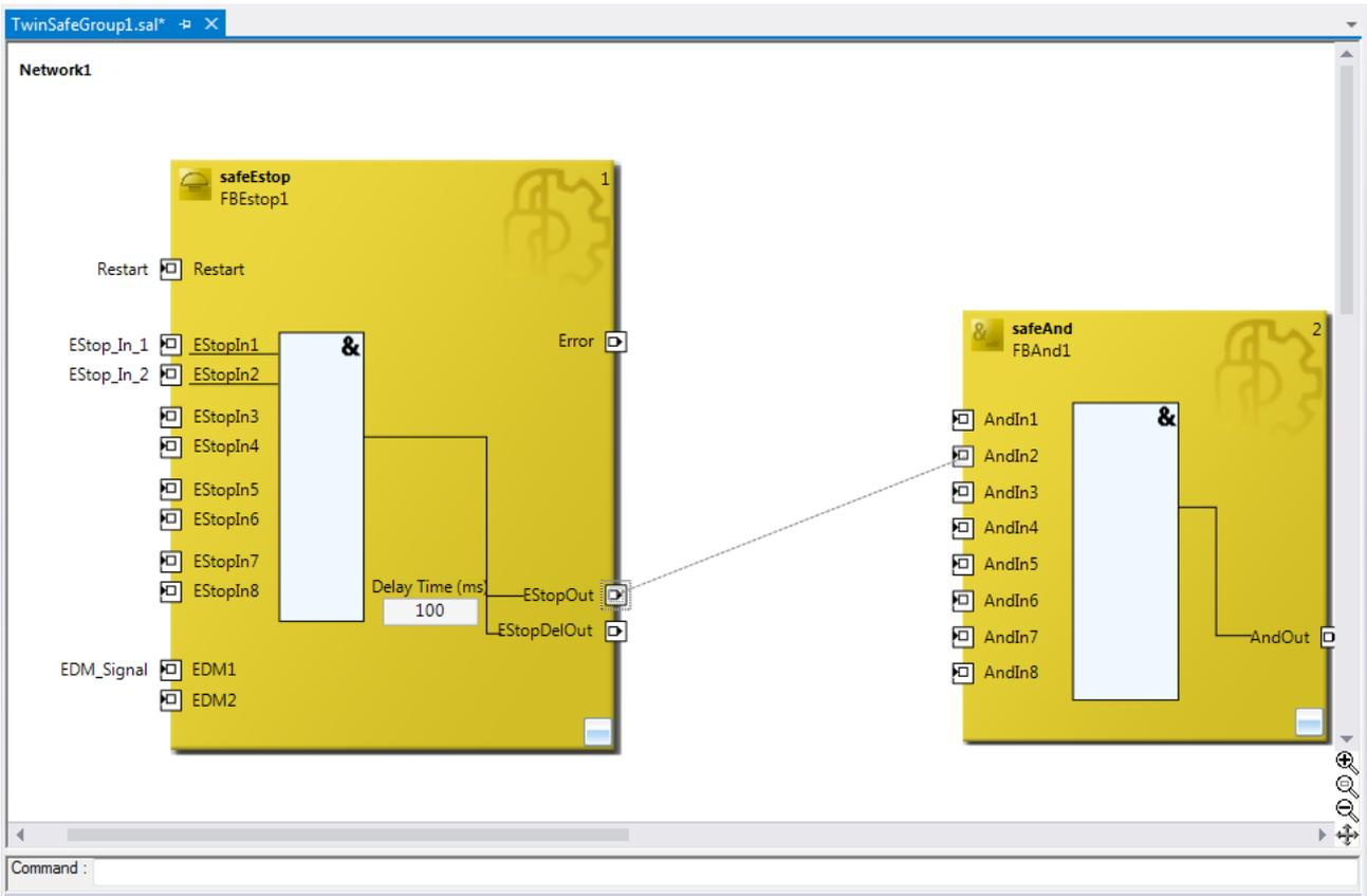
Abb. 55: Ziehen einer Verbindung zwischen zwei Bausteinen
