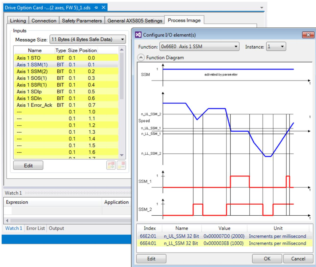
Abb. 40: AX5000-Safety-Antriebsoptionen - Function Diagram
