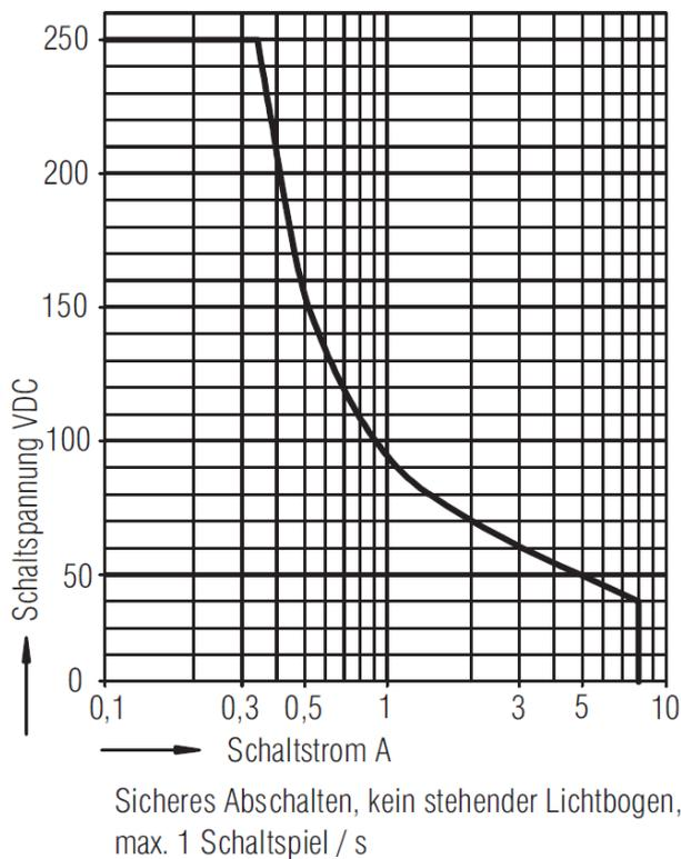
Abb. 3: Lastgrenzkurve Relais Arbeitskontakt
