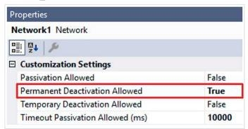
Sie sehen in den Customization Settings der STO-Funktionalität für ChA, dass die permanente Deaktivierung der Funktionalität bereits erlaubt ist.
