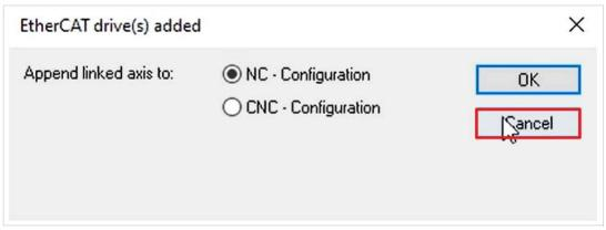
7. Fenster "EtherCAT drive(s) added" mit "Cancel" schließen, da in dieser Applikation keine NC-Konfiguration benötigt wird
