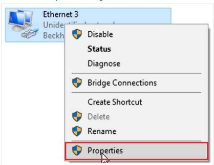
In diesem Anwendungsfall wird ein virtueller Adapter verwendet, der "Beckhoff Virtual Ethernet Adapter" heißt und bei Ethernet 3 liegt.
