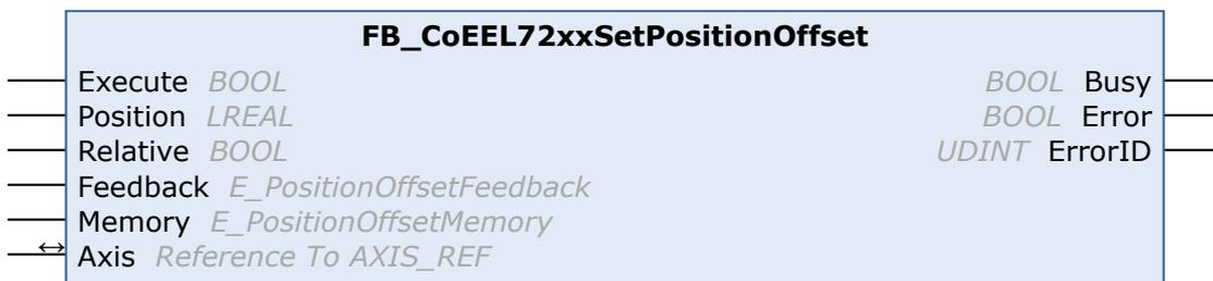
Mit dem Funktionsbaustein FB\_CoEEL72xxSetPositionOffset kann ein Positions-Offset im Speicher der EL72xx abgespeichert werden. Ein Speichern im digitalen Typenschild des angeschlossenen Motor-Encoders ist momentan nicht vorgesehen.
