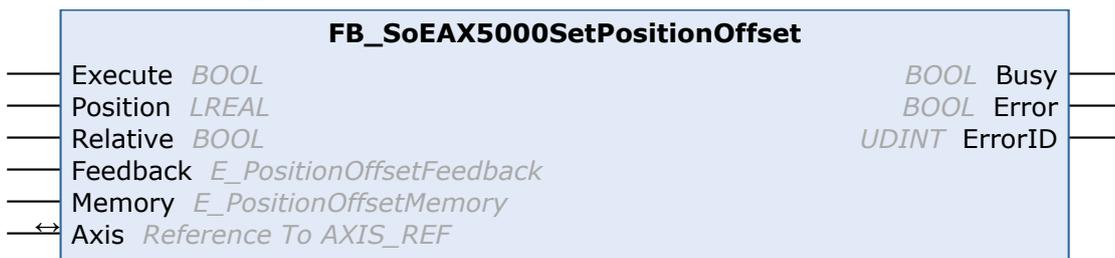
Mit dem Funktionsbaustein FB\_SoEAX5000SetPositionOffset kann ein Positions-Offset im Speicher des AX5000 oder im digitalen Typenschild des angeschlossenen Motor-Encoders abgespeichert werden. Dazu muss das Offset zuvor mit dem DriveManager konfiguriert und anschließend im Funktionsbaustein der gleiche Speicherort (Encoder / Drive) verwendet werden.
