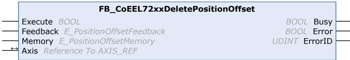
Mit dem Funktionsbaustein FB\_CoEEL72xxDeletePositionOffset kann ein Positions-Offset im Speicher der EL72xx gelöscht werden.
