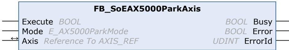
Mit dem Funktionsbaustein wird die Parkfunktionalität eines AX5000 aktiviert. Ein geparkter Kanal eines AX5000 ist temporär deaktiviert.
