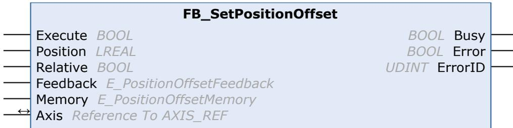
Mit dem Funktionsbaustein FB\_SetPositionOffset kann ein Positions-Offset im Speicher einer Beckhoff-Servo-Hardware abgespeichert werden. Ein Speichern im digitalen Typenschild des angeschlossenen Motor-Encoders ist ebenfalls möglich. Dazu muss das Offset zuvor mit dem DriveManager konfiguriert und anschließend im Funktionsbaustein der gleiche Speicherort (Encoder / Drive) verwendet werden.
