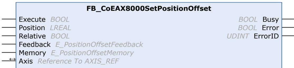
Mit dem Funktionsbaustein FB\_CoEAX8000SetPositionOffset kann ein Positions-Offset im Speicher des AX8000 oder im digitalen Typenschild des angeschlossenen Motor-Encoders abgespeichert werden. Dazu muss das Offset zuvor mit dem DriveManager konfiguriert und anschließend im Funktionsbaustein der gleiche Speicherort (Encoder / Drive) verwendet werden.
