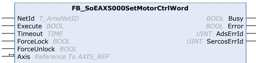
Mit dem Funktionsbaustein FB\_SoEAX5000SetMotorCtrlWord kann das ForceLock-Bit (Bit 0) bzw. das ForceUnlock-Bit im Motor Control Word (P-0-0096) gesetzt werden, um die Bremse zu aktivieren oder zu lösen. Im Normalfall wird die Bremse automatisch über das Enable des Antriebs gesteuert.
