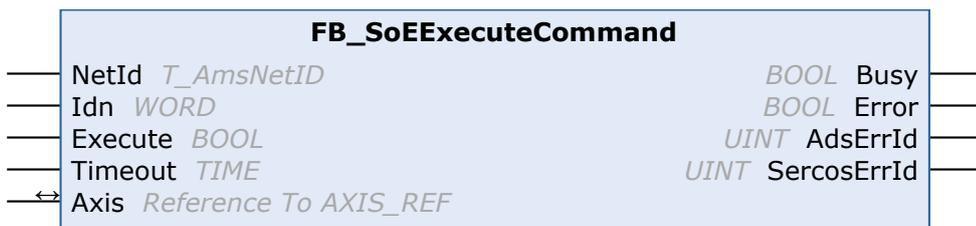
Mit dem Funktionsbaustein FB\_SoEExecuteCommand kann ein Kommando ausgeführt werden.
