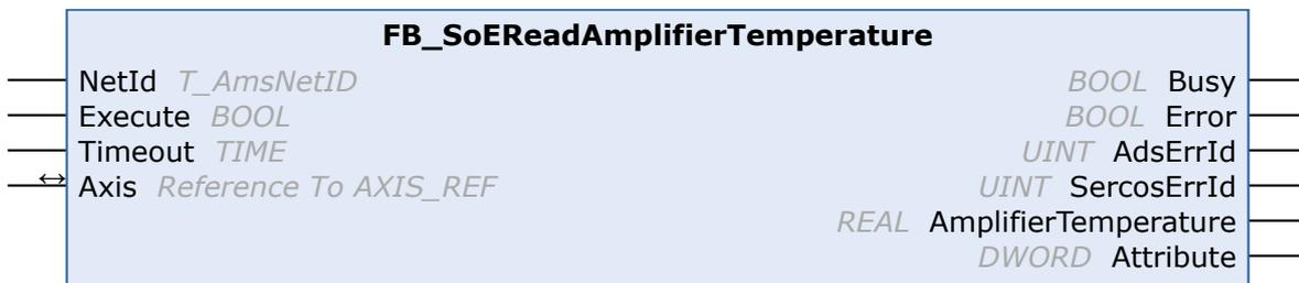
Mit dem Funktionsbaustein FB\_SoEReadAmplifierTemperature kann die Temperatur des Antriebs (S-0-0384) eingelesen werden.
