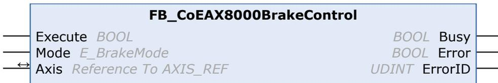
Mit diesem Funktionsbaustein kann die Bremse eines Motors, der an einem AX8000 betrieben wird, manuell geöffnet oder geschlossen werden.
