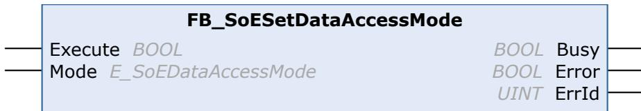
Mit dem Funktionsbaustein FB\_SoESetDataAccessMode wird der Zugriffsmodus auf SoE Parameter gesetzt. Per Default wird parallel auf Attribute & Value zugegriffen. Sollte dieser Zugriffsmodus vom Gerätehersteller nicht unterstützt werden, kann ein sequenzieller Zugriff erzwungen werden. Grundsätzlich ist aber der parallele Zugriff schneller.
