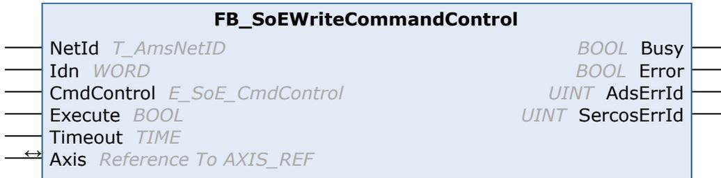
Mit dem Funktionsbaustein FB\_SoEWriteCommandControl kann ein Kommando vorbereitet, gestartet oder abgebrochen werden.
