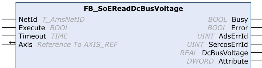
Mit dem Funktionsbaustein FB\_SoEReadDcBusVoltage kann die DC-Bus-Spannung des Antriebs (S-0-0380) eingelesen werden.
