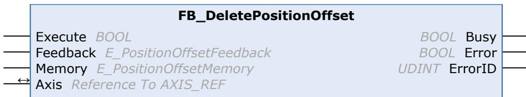
Mit dem Funktionsbaustein FB\_DeletePositionOffset kann ein Positions-Offset im Speicher einer Beckhoff-Servo-Hardware gelöscht werden.
