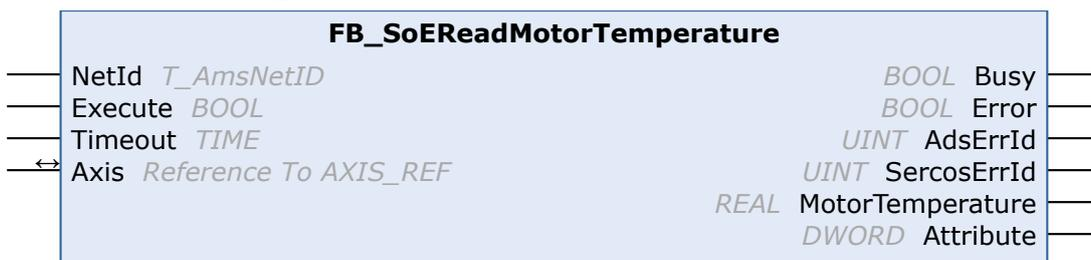
Mit dem Funktionsbaustein FB\_SoEReadMotorTemperature kann die Temperatur des Motors (S-0-0383) eingelesen werden. Wenn der Motor keinen Temperatursensor enthält, steht hier 0.0, d. h. 0.0°C.
