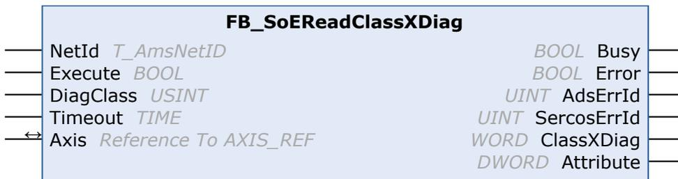
Mit dem Funktionsbaustein FB\_SoEReadClassXDiag kann die aktuelle Class-1-Diagnose (S-0-0011) ... Class-3-Diagnose (S-0-0013) als WORD ausgelesen werden. Für die Auswertung der Class-1-Diagnose als Struktur ST\_AX5000\_C1D gibt es die Konvertierungsfunktion F\_ConvWordToSTAX5000C1D (siehe Dokumentation TwinCAT 3 PLC Lib Tc2\_Drive).
