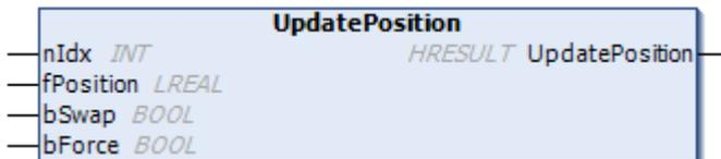
In einigen Anwendungsfällen muss die Zielposition der Segmente nach der Definition geändert werden. Diese Methode wird z.B. bei transformierenden Achsen genutzt.
