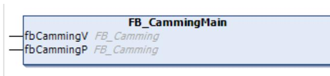
Die Eigenschaft bietet zwei Optionen: Camming.Pos für Position-Camming und Camming.Velo für Geschwindigkeit-Camming. Dazu werden zwei Klassen desselben Typs instanziiert, jedoch mit unterschiedlichen Parametrierungen.
