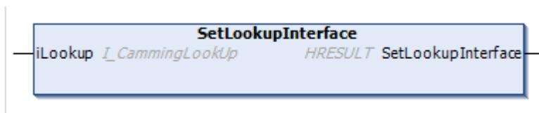
Diese Methode muss verwendet werden, um eine Camming-Tabelle anzuschließen.
