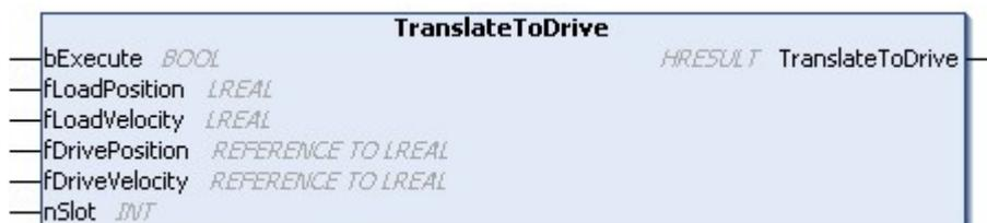
Diese Methode wird verwendet, um eine Antriebsposition über die Transformationstabelle der Lasttabelle zu berechnen.
