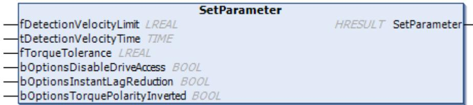
Eine Reihe von Parametern, die für diese Homing-Prozedur spezifisch sind, wird gesetzt.
