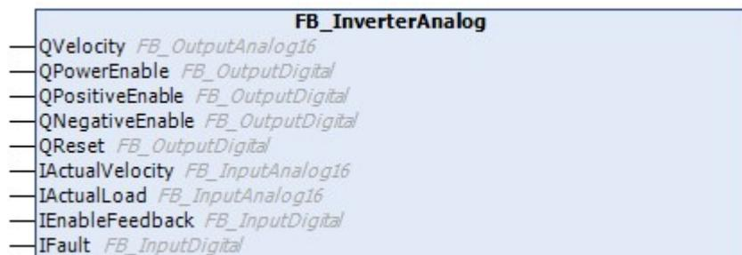
Diese Klasse wird für Umrichter mit Analog-Schnittstelle verwendet.
