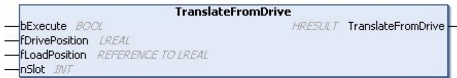
Diese Methode wird verwendet, um eine Lastposition über die Transformationstabelle der Lasttabelle zu berechnen.
