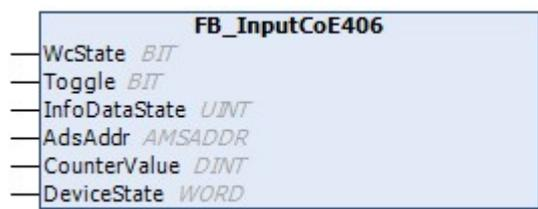
Diese Klasse kann für einen DS406 basierten Geber verwendet werden. Der Begriff CoE (CAN over EtherCAT) bezieht sich in diesem Kontext auf die Übertragung des CiA DS406-Protokolls über EtherCAT.
