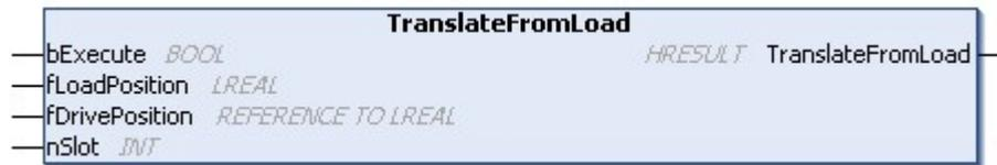
Diese Methode wird verwendet, um eine Antriebsposition über die Transformationstabelle der Antriebsseite zu berechnen.
