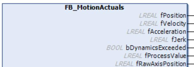
Diese Corefunction wird nicht direkt instanziiert. Sie wird als gemeinsamer Teil von typspezifischen Corefunctions wie ActualsHydraulics, ActualsNc oder ActualsActuator verwendet.
