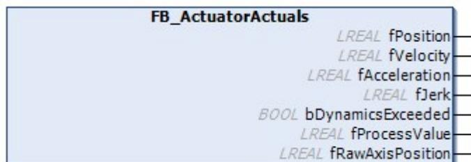
Diese Corefunction wird verwendet, um eine Zusammenstellung von Istwerten eines Aktuators darzustellen. Es ist eine Erweiterung von Actuals und erweitert den Bereich seines Elternelements, indem es spezifische Interpretationen für Aktuatoren hinzufügt.
