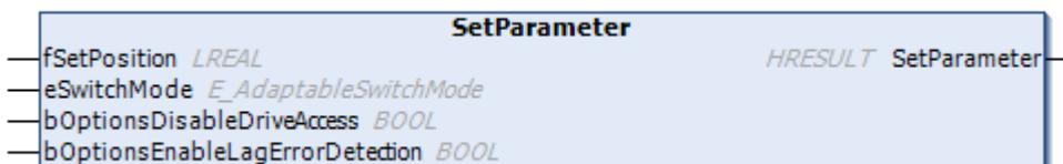
Eine Reihe von Parametern, die für diese Homing-Prozedur spezifisch sind, wird gesetzt.
