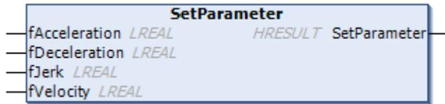
Diese Methode wird verwendet, um die Parameter einer Bewegung im Tipbetrieb festzulegen.
