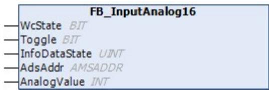
Diese Klasse kann für ein 16 bit Analog-Eingangselement verwendet werden.
