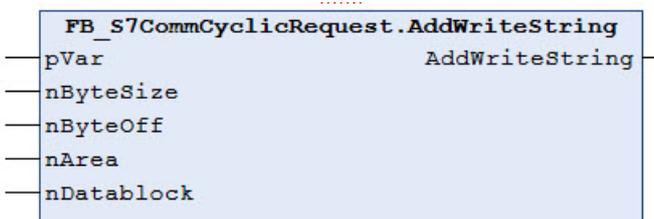
Fügt ein Schreib-Kommando auf einen S7 Datenpunkt vom Typ STRING zu einem Request hinzu. Der Datenpunkt wird über seine absolute Adresse in der S7 Steuerung spezifiziert. Die maximale Länge des Strings darf 254 Zeichen nicht überschreiten.
