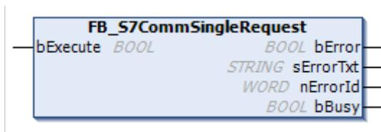
Mit dem Funktionsbaustein FB\_S7CommSingleRequest kann ein read/write Request auf einen Datenpunkt einer S7 Kommunikationsverbindung durchgeführt werden. Über den Ausgang bError kann festgestellt werden, ob der Request erfolgreich durchgeführt wurde. Eventuell auftretende Fehler beim Request werden über den Ausgang sErrorTxt und nErrorId angezeigt.
