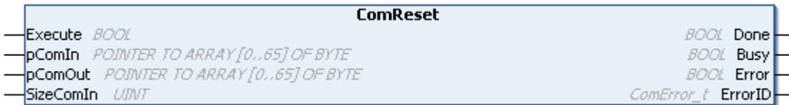
ComReset führt einen Reset der angeschlossenen seriellen Hardware durch. Dadurch werden die Hardware-internen Sende- und Empfangspuffer gelöscht. Der Funktionsbaustein unterstützt verschiedene serielle Hardware wie die serielle PC-Schnittstelle und die seriellen Busklemmen KL6xxx.
