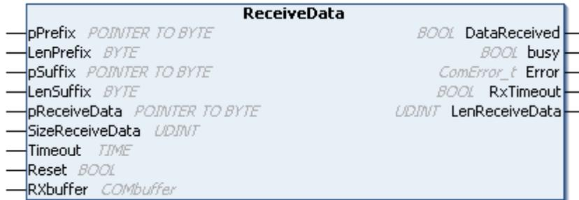
**ReceiveData** empfängt Daten beliebigen Typs von der mit der Eingangsvariablen **RxBuffer** korrespondierenden Schnittstelle und speichert sie in der Variablen **ReceiveData**. Anfang und Ende des Datenstromes werden über verschiedene miteinander kombinierbare Mechanismen erkannt:
