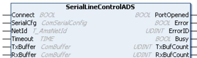
Der Funktionsbaustein *SerialLineControlADS* wickelt die Kommunikation zwischen einer virtuellen seriellen Schnittstelle und der SPS ab. Der Funktionsbaustein wird zyklisch aufgerufen und stellt empfangene Daten im *RxBuffer* bereit. Gleichzeitig werden im Sendepuffer *TxBuffer* bereitgestellte Daten zur Schnittstelle übertragen.
