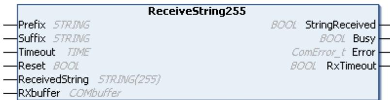
Der Funktionsbaustein **ReceiveString** empfängt eine Zeichenkette von der mit der Eingangsvariablen **RxBuffer** korrespondierenden Schnittstelle und speichert sie in der Ausgangsvariablen **ReceivedString**. Anfang und Ende der Zeichenkette werden über verschiedene miteinander kombinierbare Mechanismen erkannt.
