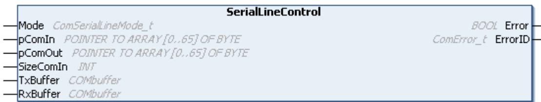
Der Funktionsbaustein SerialLineControl wickelt die Kommunikation zwischen einer seriellen Schnittstelle (KL60xx, EL60xx oder COM-Schnittstelle) und der SPS ab. Der Funktionsbaustein wird zyklisch aufgerufen und stellt empfangene Daten im *RxBuffer* bereit. Gleichzeitig werden im Sendebuffer *TxBuffer* bereitgestellte Daten zur Schnittstelle übertragen.
