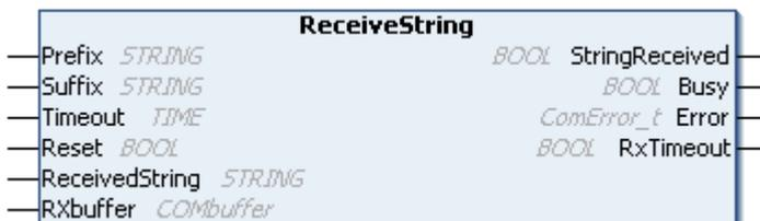
Der Funktionsbaustein ReceiveString empfängt eine Zeichenkette von der mit der Eingangsvariablen **RxBuffer** korrespondierenden Schnittstelle und speichert sie in der Ausgangsvariablen **ReceivedString**. Anfang und Ende der Zeichenkette werden über verschiedene miteinander kombinierbare Mechanismen erkannt.
