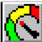
Mit dem Befehl können Sie ein Zeigerinstrument in Ihre aktuelle Visualisierung einfügen. Es bietet eine Skala, die auf einem zu definierenden Kreisbogenausschnitt liegt, und einen Zeiger, der seinen Ursprung in der virtuellen Kreismitte hat.
