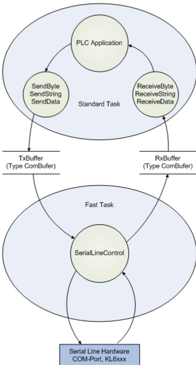
Zur Entkopplung der unterschiedlichen Geschwindigkeiten zwischen der schnellen Kommunikations-Task und der Standard-Task werden Datenpuffer vom Typ [ComBufer \[► 35\]](#) verwendet, die asynchron beschrieben und gelesen werden.
