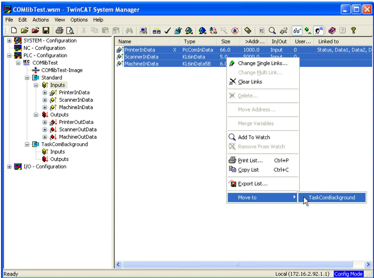
Da die Zykluszeit der Task über den Update-Zyklus auf dem I/O-Bus entscheidet, ist es unbedingt erforderlich, die Datenstrukturen zur Kommunikation zwischen schneller Kommunikations-Task und der Hardware dieser Task zuzuordnen. Die entsprechenden Einträge unterhalb der Ein- und Ausgänge der Standard-Task werden mit der Maus oder über das *Move to* Kommando im Kontextmenü in die Kommunikations-Task verschoben.
