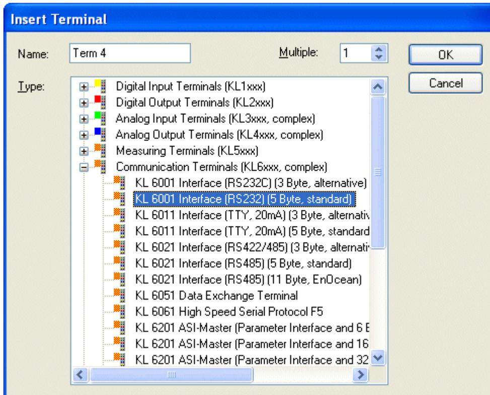
Anschließend werden die Ein-/Ausgangsdaten einzeln mit den korrespondierenden Variablen der SPS verknüpft (Typ [KL6inData5B](#) [► 37] bzw. [KL6outData5B](#) [► 37]).
