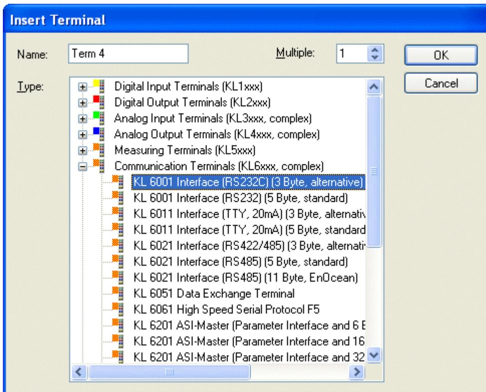
Anschließend werden die Ein-/Ausgangsdaten einzeln mit den korrespondierenden Variablen der SPS verknüpft (Typ `KL6inData` [▶ 37] bzw. `KL6outData` [▶ 37]).
