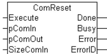
ComReset führt einen Reset der angeschlossenen seriellen Hardware durch. Dadurch werden die Hardware-internen Sendepuffer und Empfangspuffer gelöscht. Der Funktionsbaustein unterstützt verschiedene serielle Hardware wie die serielle PC-Schnittstelle und die seriellen Busklemmen KL6xxx.
