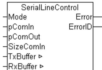
Der Funktionsbaustein SerialLineControl wickelt die Kommunikation zwischen einer seriellen Schnittstelle (KL60xx, EL60xx oder COM-Schnittstelle) und der SPS ab. Der Funktionsbaustein wird zyklisch aufgerufen und stellt empfangene Daten im *RxBuffer* bereit. Gleichzeitig werden im Sendebuffer *TxBuffer* bereitgestellte Daten zur Schnittstelle übertragen.
