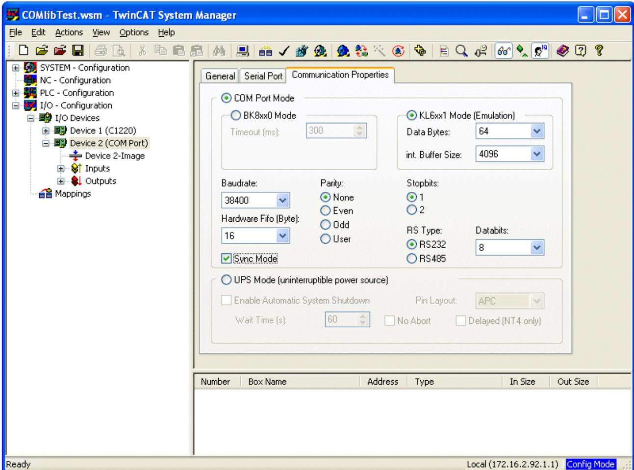
Die COMlib unterstützt nur den KL6xx1 Emulationsbetrieb. Die Anzahl der **Datenbytes** muss auf **64 Byte** eingestellt werden. Die Schnittstellenparameter werden der Anwendung entsprechend eingestellt.
