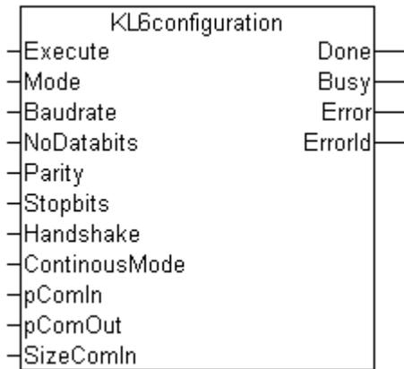
Der Funktionsbaustein KL6configuration initialisiert und konfiguriert eine serielle Busklemme KL6xxx.
