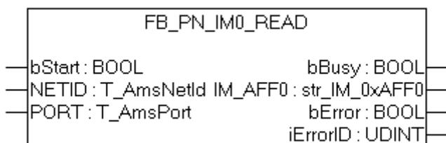
Mit diesem Funktionsbaustein liest der PROFINET-Controller alle I&M 0 ( Identification & Maintenance ) Daten aus einem über den Eingang *Port* referenzierten Gerät.
