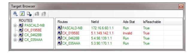
Wenn sich ein Gerät im Run Modus befindet, kann bis hin zum Basis Datentyp in die Datenstruktur der einzelnen Ports bzw. Tasks gebrowst werden. Dort können Sie dann Ihre Kanäle per Multiselect, wie unten im Bild dargestellt, auswählen und per Rechtsklick den Befehl "To Channel" ausführen.
