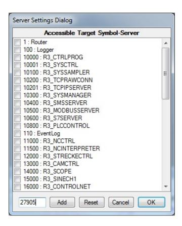
4. Jetzt sollte im TwinCAT Scope 2 Target Browser *AdsPort of Image 1 (27905)* erscheinen. Über diesen neuen Eintrag kann man in die EtherCAT Klemmen und so auch in die gewünschte Oversampling-Klemme hinein browsen. In der Oversampling-Klemme sollte die rot gekennzeichnete Variable mit dem Zusatz [T20] (20 steht in diesem Fall für 20-fach Oversampling, diese Zahl kann entsprechend dem Oversampling-Faktor variieren) für die Scope-Aufnahme ausgewählt werden.
