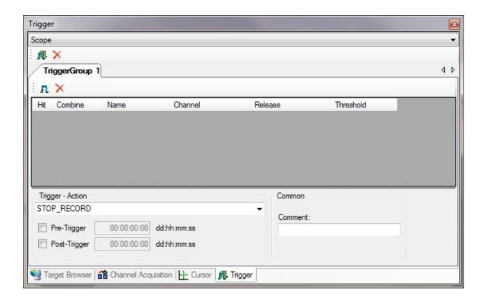
Unter Trigger-Action wählen Sie bitte STOP\_RECORD aus. Mit dieser Option ist es möglich eine Laufende Aufnahme wie gewünscht zu stoppen. Sobald Sie diese Option auswählen, werden Sie je nach Scope Settings darauf aufmerksam gemacht, dass diese Option nur im Ring Buffer Mode sinnvoll ist und genutzt werden kann (siehe nächste Abbildung).
