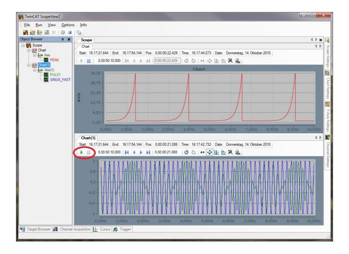
Unabhängig davon, ob Sie das Display gestoppt haben oder nicht, ist es möglich im Chart-Fenster in der ersten Eingabebox von links die aktuelle Display-Weite einzustellen. Diese Möglichkeit soll im nächsten Bild für das Peak Signal gezeigt werden. Für die beiden anderen Signale, dessen Display gestoppt ist, werden zwei Cursor gesetzt, das Signal gezoomt und verschoben.
