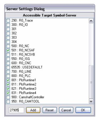
Hier werden alle gängigen Ads-Ports, unabhängig davon ob es sich um einen Server-Tasks handelt, angezeigt. Ist ein Port hier nicht aufgeführt kann er im Textfeld unten links eingegeben werden. Alle selektierten Ports, bei denen es sich um Server handelt, werden nach dem bestätigen mit OK übernommen. Anschließend wird geprüft, welche der Ports existieren, um die Anzeige zu aktualisieren.
