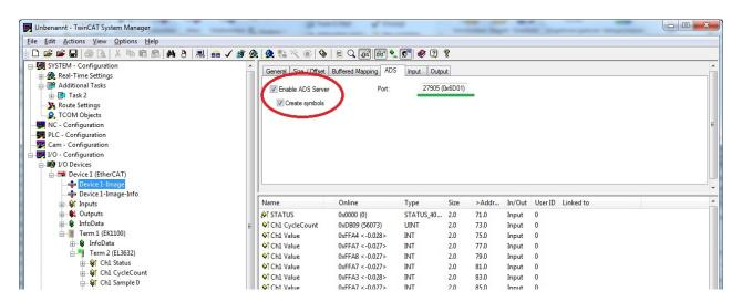
2. Für die entsprechende Oversampling Klemme sollte der gewünschte Oversampling-Faktor im TwinCAT System Manager eingestellt werden, bevor dann die Konfiguration aktiviert wird.
