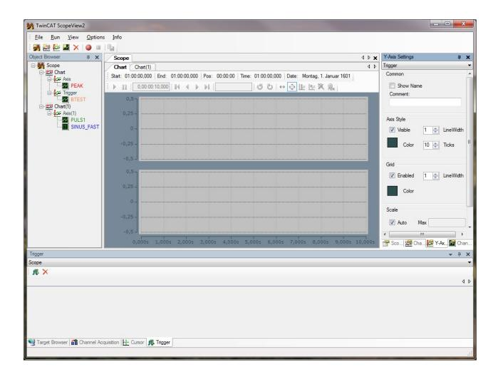
Die beiden Button in der Trigger-Kartei sind zum hinzufügen und entfernen von Trigger-Gruppen, in welchen verschiedene Signale und dessen Grenzwerte mit AND und/oder OR verknüpft werden können, um so eine Triggeraktion auszulösen. Fügen Sie nun eine Trigger-Gruppe hinzu. Ziel dieser Trigger-Gruppe ist es auf eine steigende Flanke von bTest zu reagieren und so die bereits gestartete Aufnahme zu beenden.
