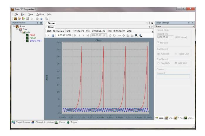
Abhilfe kann in diesem Fall eine zweite Y-Achse im selben Chart bieten, welche man direkt zur Laufzeit einfügen kann. Einfach das Achsen-Symbol in der Toolbar anwählen und schon wird im aktuell selektierten Scope bzw. Chart eine Y-Achse eingefügt.
